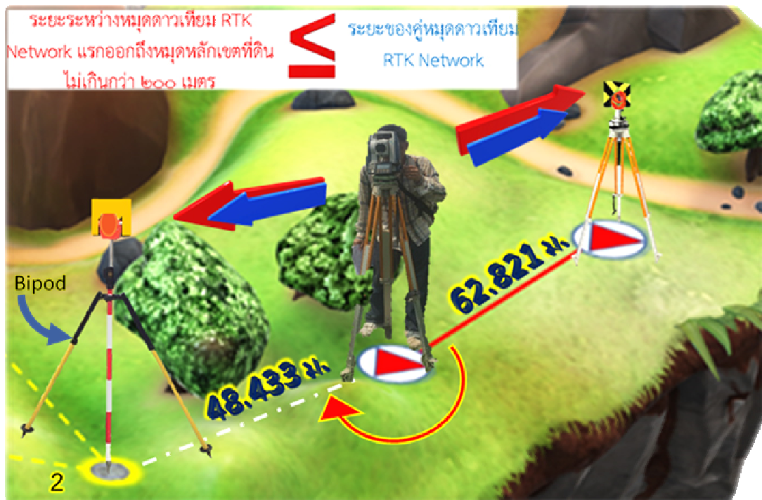
รูปภาพแสดงการรังวัดโยงยี่ดหลักหมุดเขตที่ดินจากหมุดดาวเทียม RTK Network โดยตรง
