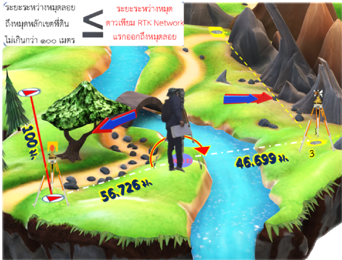
รูปภาพแสดงการโยนยึดหมุดหลักเขตที่ดินจากหมุดลอยที่ออกจากหมุดดาวเทียม RTK Network
