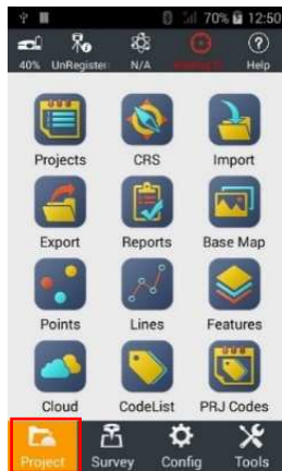
เลือก เมนู Project ในแอปพลิเคชัน Landstar
