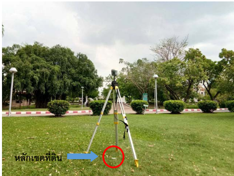
รูปภาพแสดงการเลือกตำแหน่งในการรับสัญญาณดาวเทียมโดยตรงบนหัวหลักเขตที่ดิน
