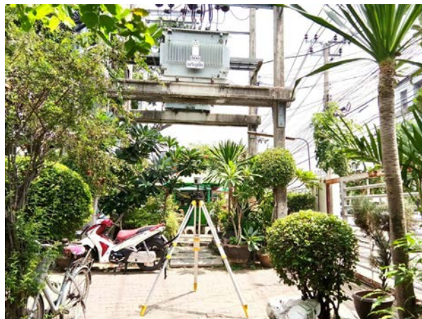
รูปภาพแสดงตำแหน่งใกล้หม้อแปลงไฟฟ้า ซึ่งเป็นตำแหน่งที่ไม่เหมาะสมในการรับสัญญาณดาวเทียม
