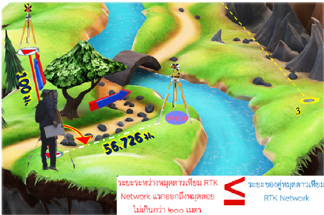
รูปภาพแสดงการสร้างหมุดลอยออกจากหมุดดาวเทียม RTK Network
