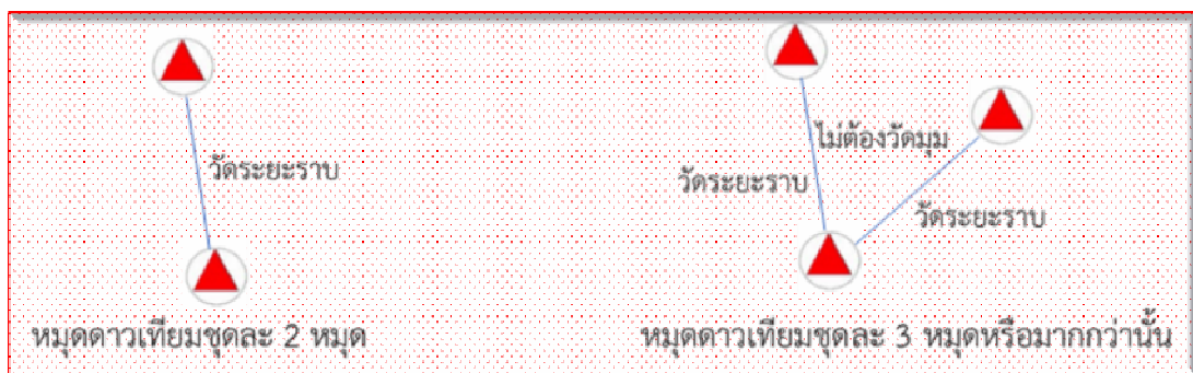
รูปภาพแสดงการสร้างหมุดดาวเทียม ชุดละ 2 หมุด หรือมากกว่านั้น
