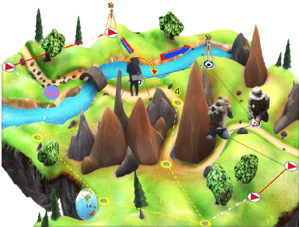
รูปภาพแสดงการวางเส้นโครงการนหมุดหลักฐานแผนที่เพื่อใช้ในการรังวัดที่ดิน
