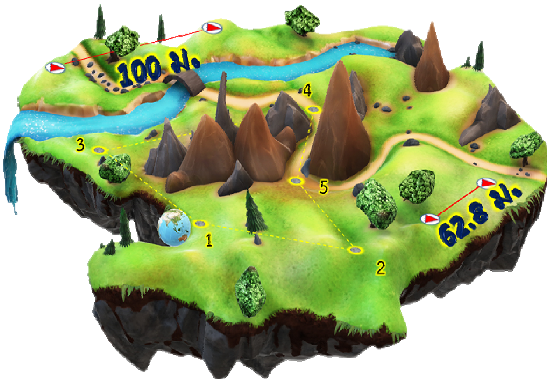
รูปภาพแสดงการสร้างคุ่มุดดาวเทียม จำนวน 2 คุ่ม ในแปลงรังวัดที่ดินเดียวกัน
