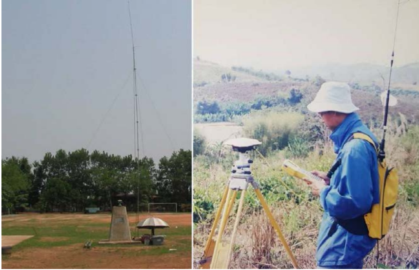
รูปภาพแสดงการรังวัดด้วยดาวเทียมแบบจลน์ในทันที (RTK GPS) แบบดั้งเดิม โดยมีหมุดดาวเทียมที่เป็นสถานีฐาน (Base) (ภาพซ้าย) และหมุดดาวเทียมที่ต้องการรังวัด (Rover) (ภาพขวา)
